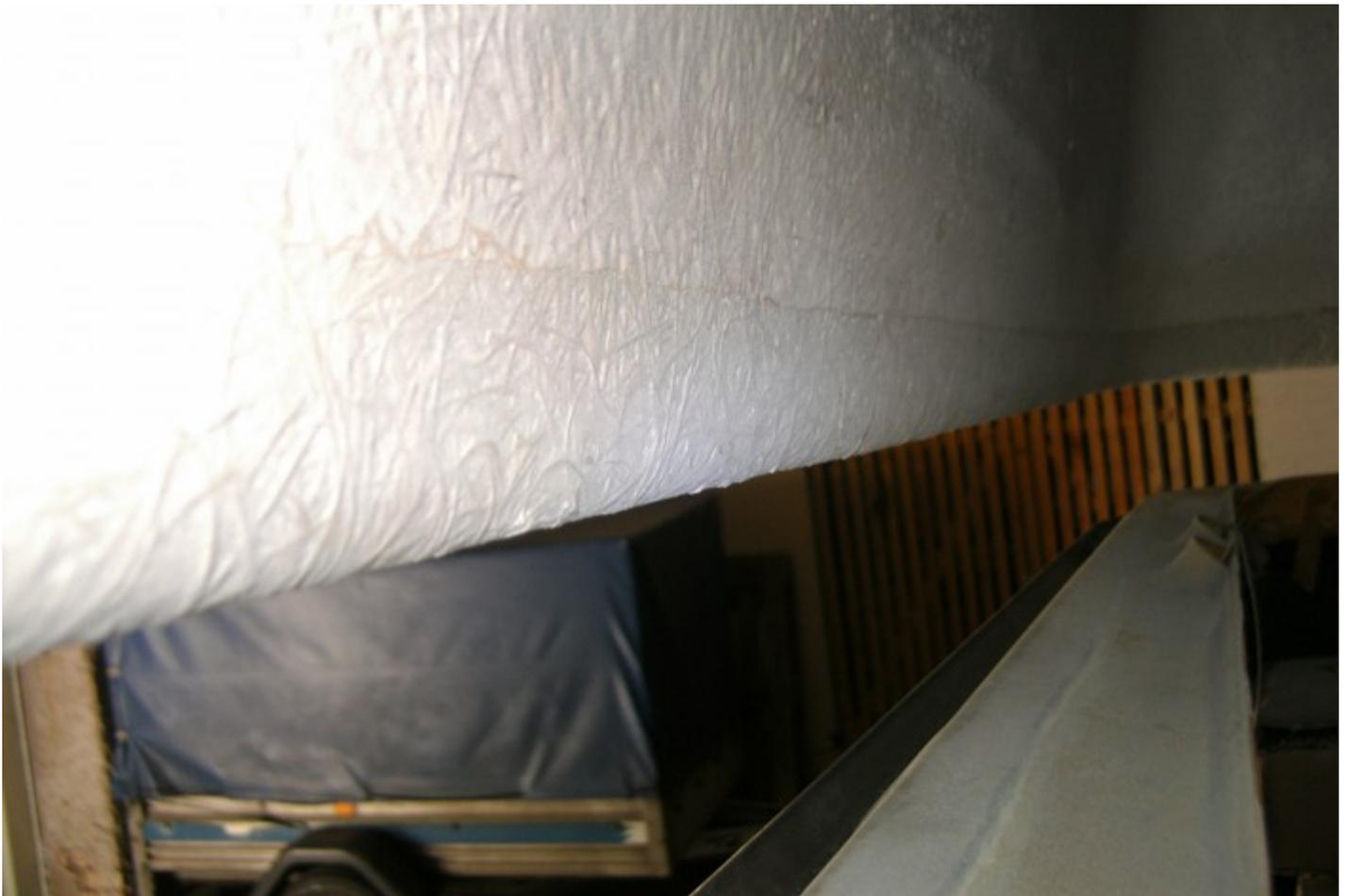
GFK Klebeflächenrand: Kit entfernt mit einer Drahtbürste, oder eine für die Bohrmaschine, geht es mit Gefühl und langsamer Umdrehung sauber ab. Das GFK sollte nicht beschädigt werden, es hat die Neigung Wasser zu ziehen.
