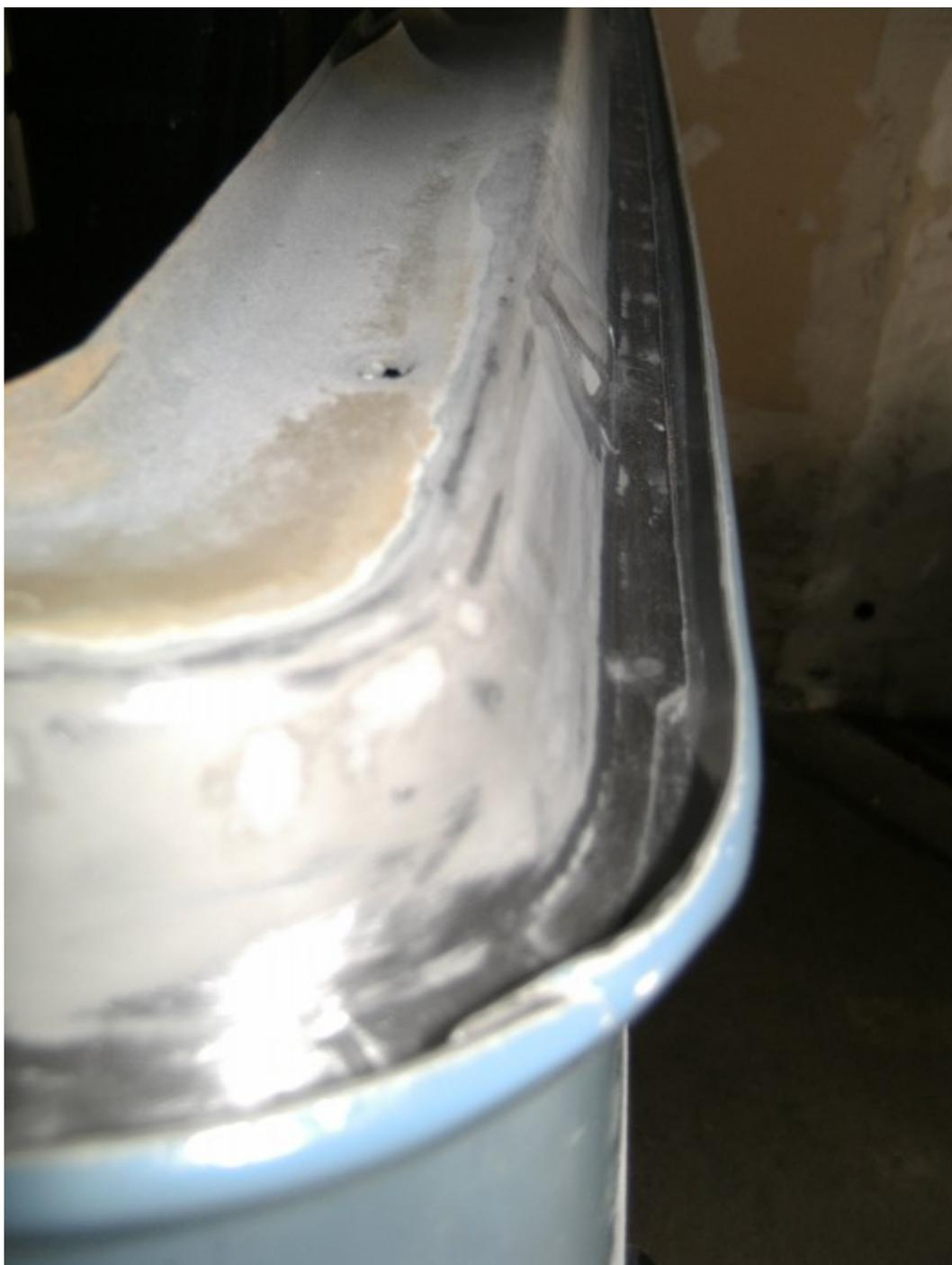
Freilegung: Mit Stilen aus Hartplaste oder Hartholz die Spitze kann beliebig angefeilt werden Kit überm GFK Rand entfernen, 13 Metallklammern entfernen, Dachrand ein Stück abschneiden mit einem Multitool, Kit schneiden mit Bowdenzug und wenn es schwer ging von Innen mit einer angeschliffenen Spachtel den Kleber vorschneiden. Dach abheben.
